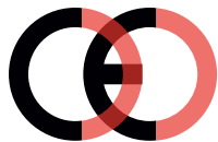
Falsche CE-Kennzeichnung (zu dicht)
