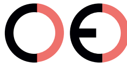
Falsche CE-Kennzeichnung (zu großer Zwischenraum)
